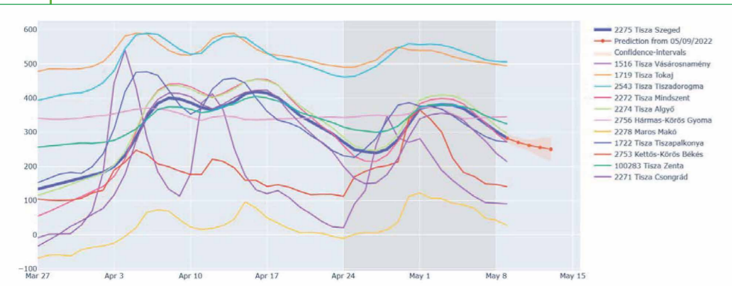
4. ábra: Az előrejelző modell működése: A szürkével jelölt rész a múltbeli időablak, a vastag vonallal ábrázolt idősorra (2275, Szeged) történik a predikció, amelynek első napja 2022. május 9.-e, a becsült adatpontokat pedig megjelenítettük a görbén. Az előrejelzés köré rajzolt konfidencia-sáv a becslés bizonytalanságát fejezi ki (az időben előrehaladva egyre szélesebb tölcserít látunk). A jelmagyarázaton a többi vízmérce a bemeneti adatsorokat mutatja, a modell ezekből becsülte meg a jövőbeli értékeket. (Forrás: Fehérvári I. 2022.)
