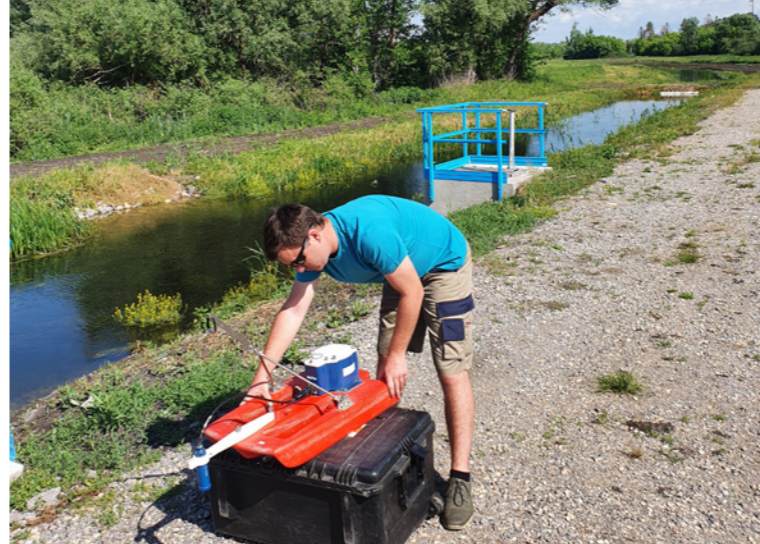
StreamPro kishajós ADCP műszer iránytű kalibrálása
