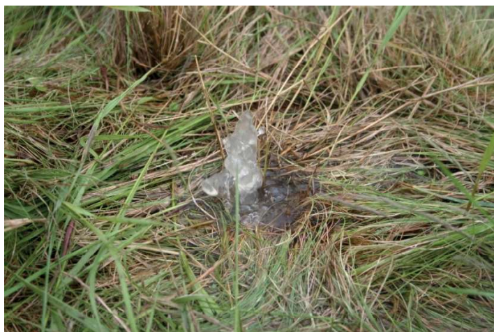
5. Felpúposodás felszúrását követő vízfeltörés a Körtevényesi őrzárásban (2006.)
