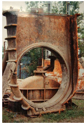
A Mindszent II. sztp. meghibásodott tolózár maradványa
